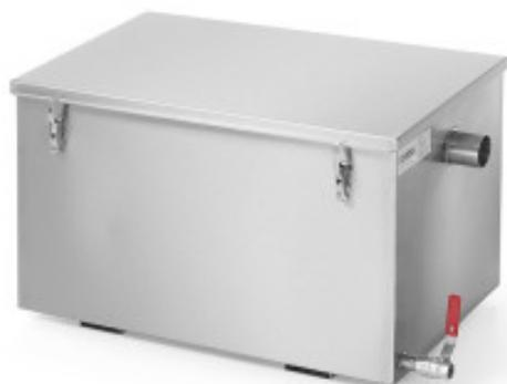
Idéal pour les restaurateurs, ce **Bac à Graisse** dispose d'un débit de 600 L/H. Il est conçu pour empêcher les graisses de bloquer le réseau d'égouts et convient particulièrement pour un usage intérieur (zones de lavage de la vaisselle, cuisines). Fabriqué en acier inoxydable, il est compact et possède un couvercle hermétique fixé par quatre pinces.
